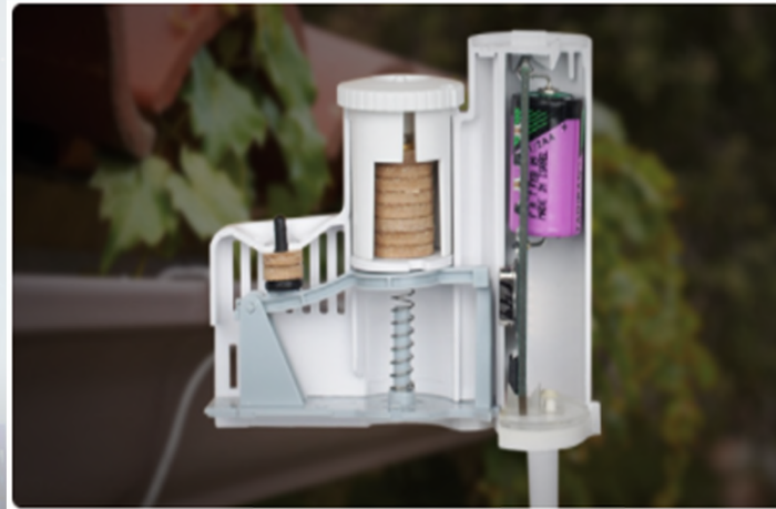
Yağmur sensörü a.) dış görüntü, b.) cihaz içerisinde genişleyebilen diskler
